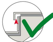
Zwischen Setzstufe und Stufenplatte bzw. Schenkel einen 3-4 mm großen Luftspalt lassen. Nicht vermörteln.
